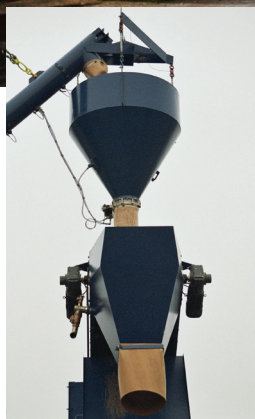
Cementvåg med omlastningsstup
